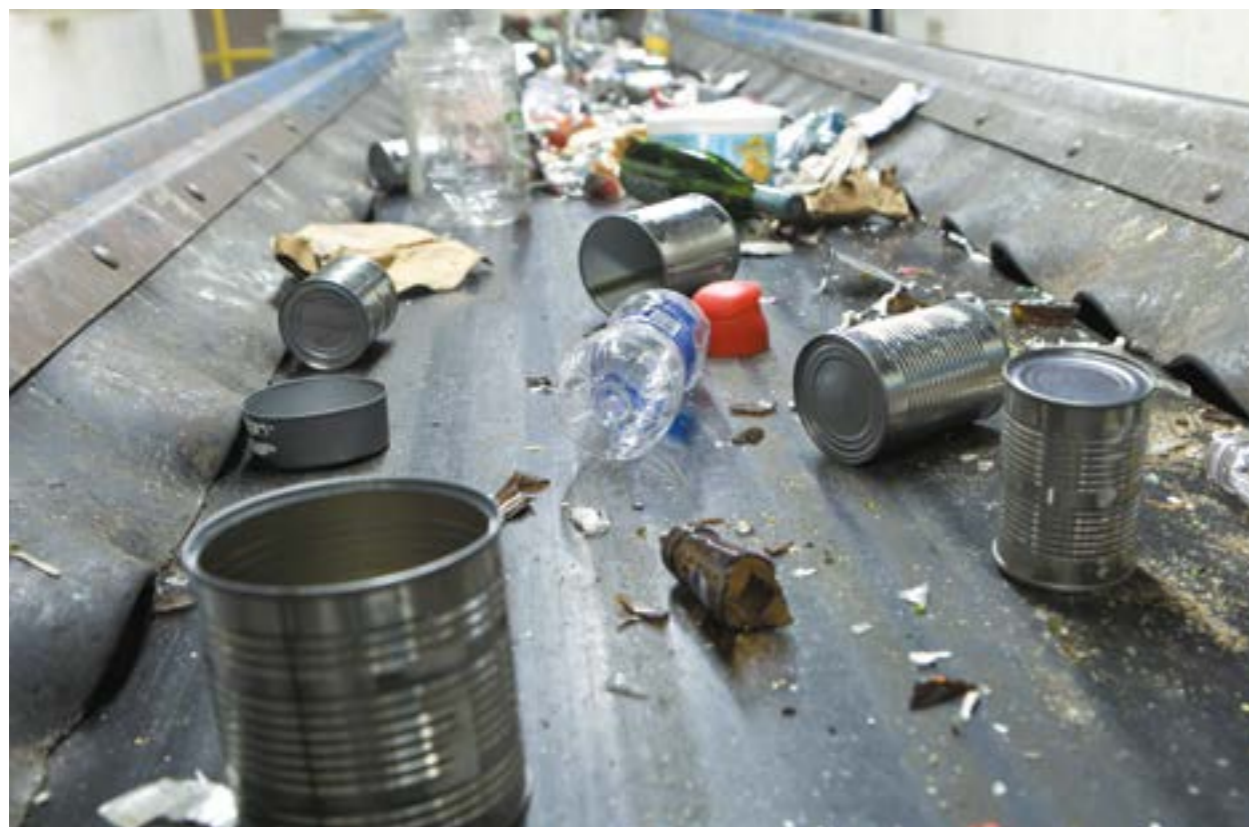
Öl- und fettbeständige Fördergurte im Einsatz in einem Recyclingwerk
