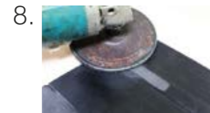
8. Nach 30 Minuten kann die Stelle nachbearbeitet werden
