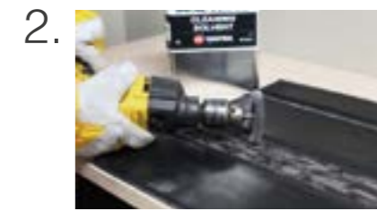
2. Anrauen der Bearbeitungsfläche
